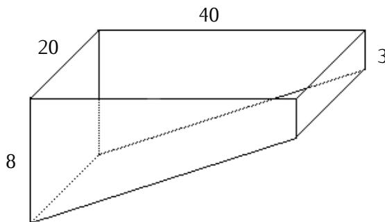
Figura 1.16: Colector de aguas lluvia.
