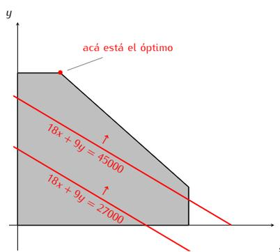
Figura 3.5: Encontrando el óptimo para el ejemplo 3.4.
